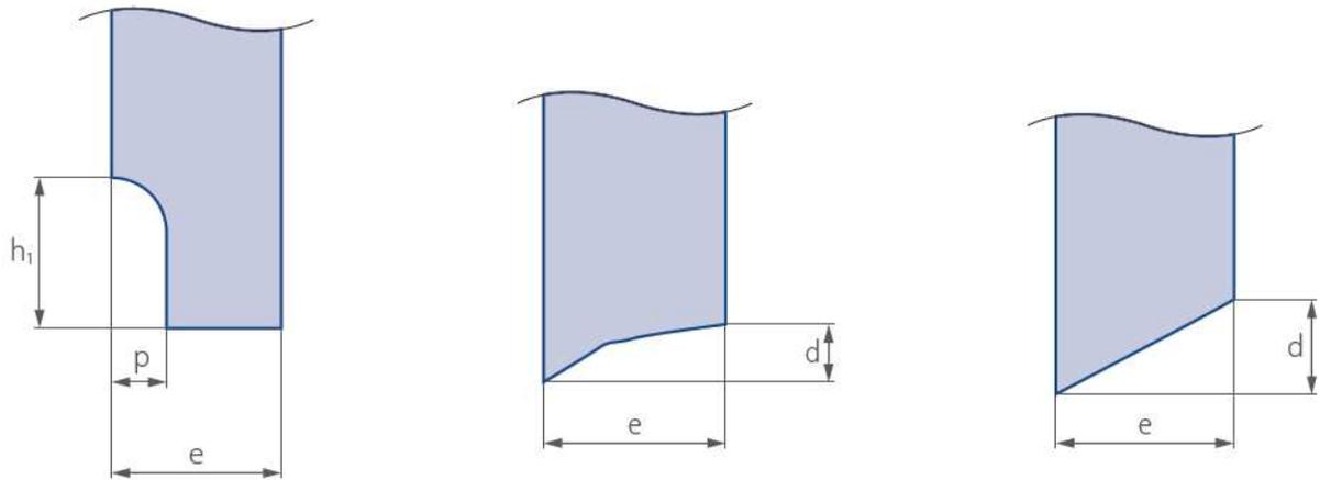
Fig. 4 Edge Defects
