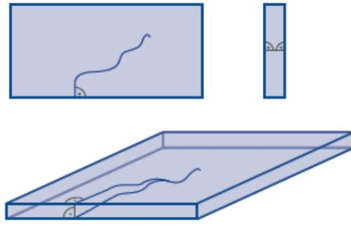
h) Thermal cracking
